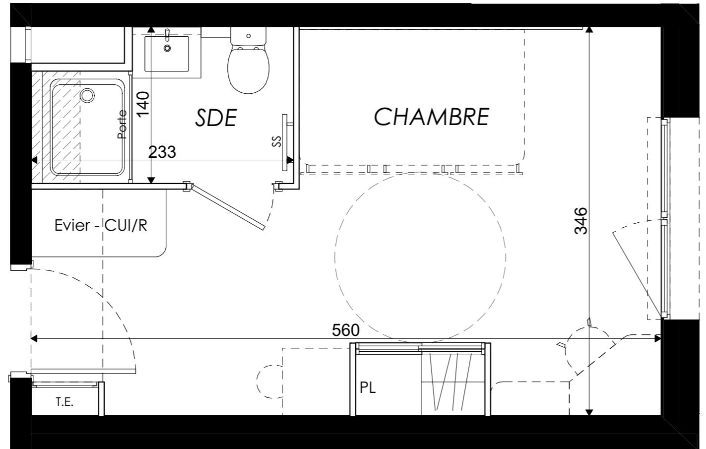
LEGENDE: PF : Porte Fenêtre / PV : Porte Vitrée / F : Fenêtre / AV : Allège Vitrée / VR : Volet Roulant / TE : Tableau Electrique / PL : Placard / CUI : Cuisson / R : Réfrigérateur / SS : Sèche Serviettes / GC : Garde-corps / Soffite, faux plafond Hauteur &gt; 2.2m
